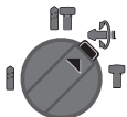
Posisjon Vario-Lock til innstilling av meiselposisjonen I denne posisjonen går slag-/dreiestopp-bryteren 13 ikke i lås.
